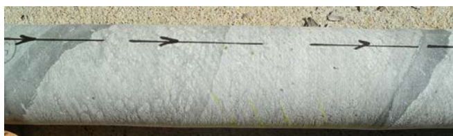
岩心上的定向线。箭头指钻孔钻进(down-hole) — 远离井口方向，尽管钻孔在坑道中可能指向上
